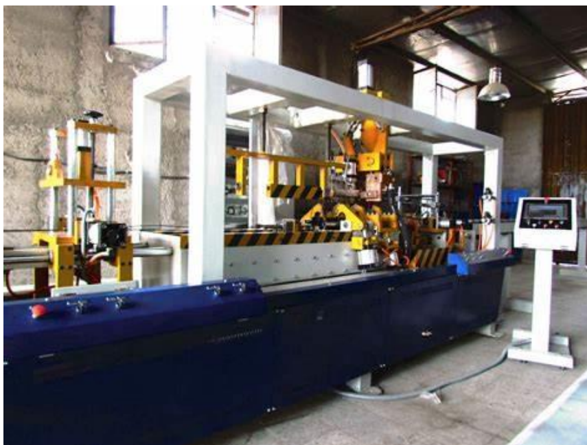
شکل ۶: دستگاه تولید تیرچه صنعتی
