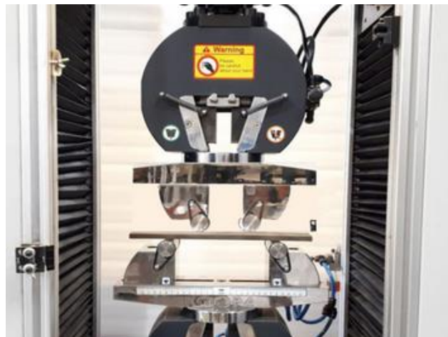
شکل ۱۴- تست خمش ۴ نقطه‌ای
