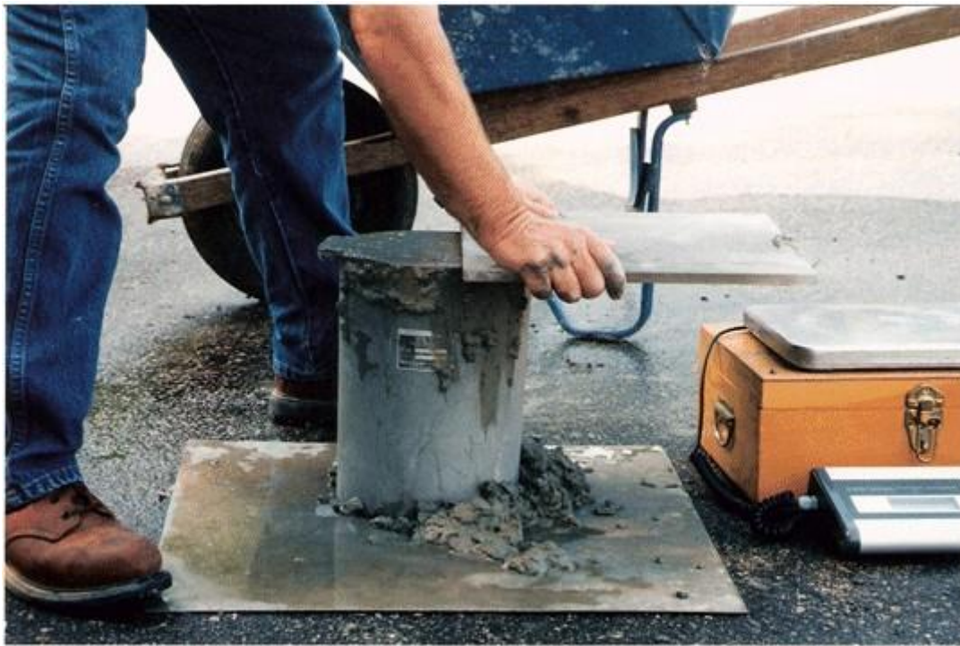
شکل ۳: تست چگالی بتن ویژه در محل
