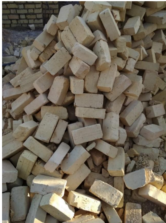
شکل ۱۱: آجر فشاری توپر
