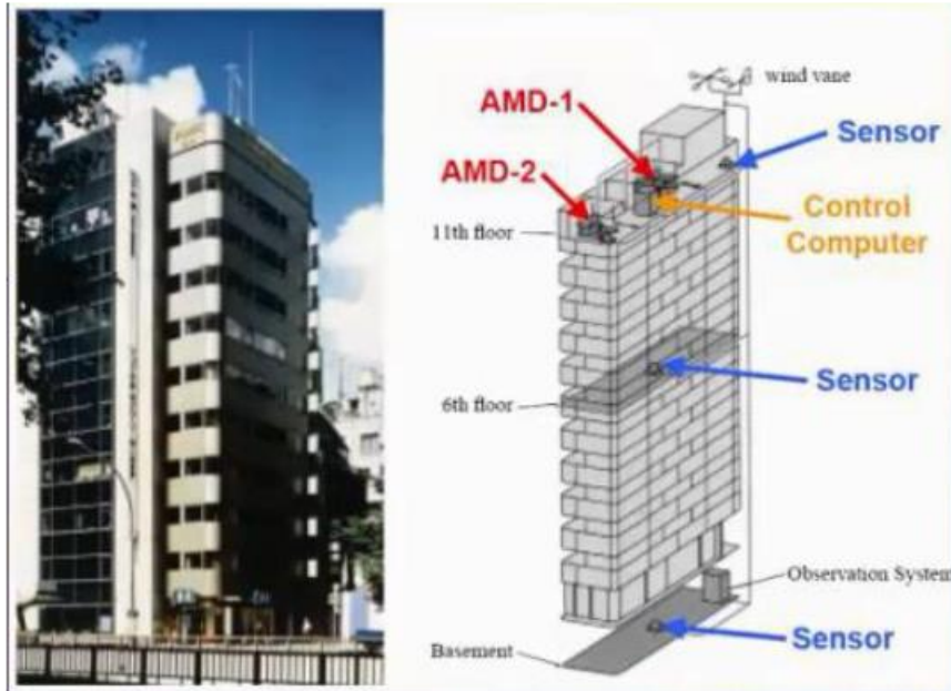
شکل ۶ کاربرد ۲ میراگر جرمی تنظیم شونده فعال در بام ساختمان ۱۱ طبقه ژاپن
