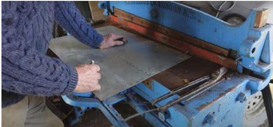
شکل ۶- برشکاری به روش کوپال
